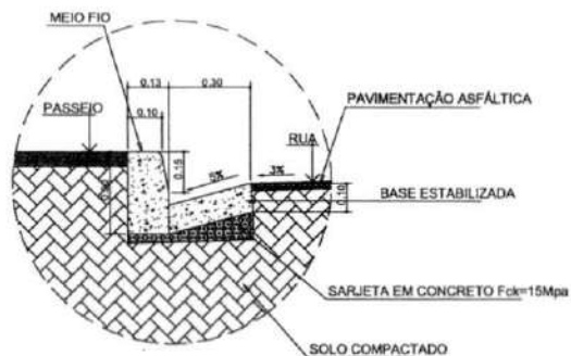
DETALHEM DRENAGEM SUPERFICIAL SEM ESCALA
